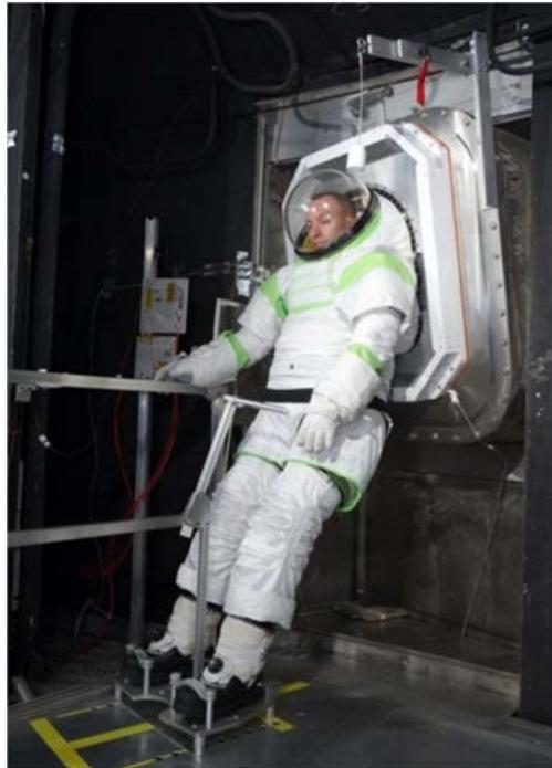
**FIGURE 4.1-4 SUITPORT TESTING IN CHAMBER B**
